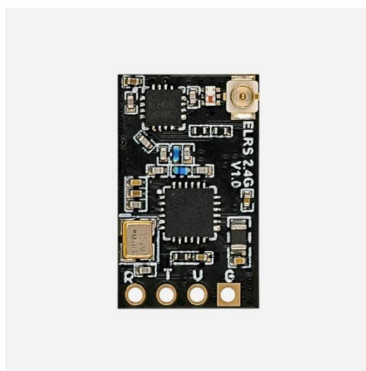
Рис 1.8 сучасна система радіокерування з відкритим кодом для FPV-дронів (ELRS 2.2)
