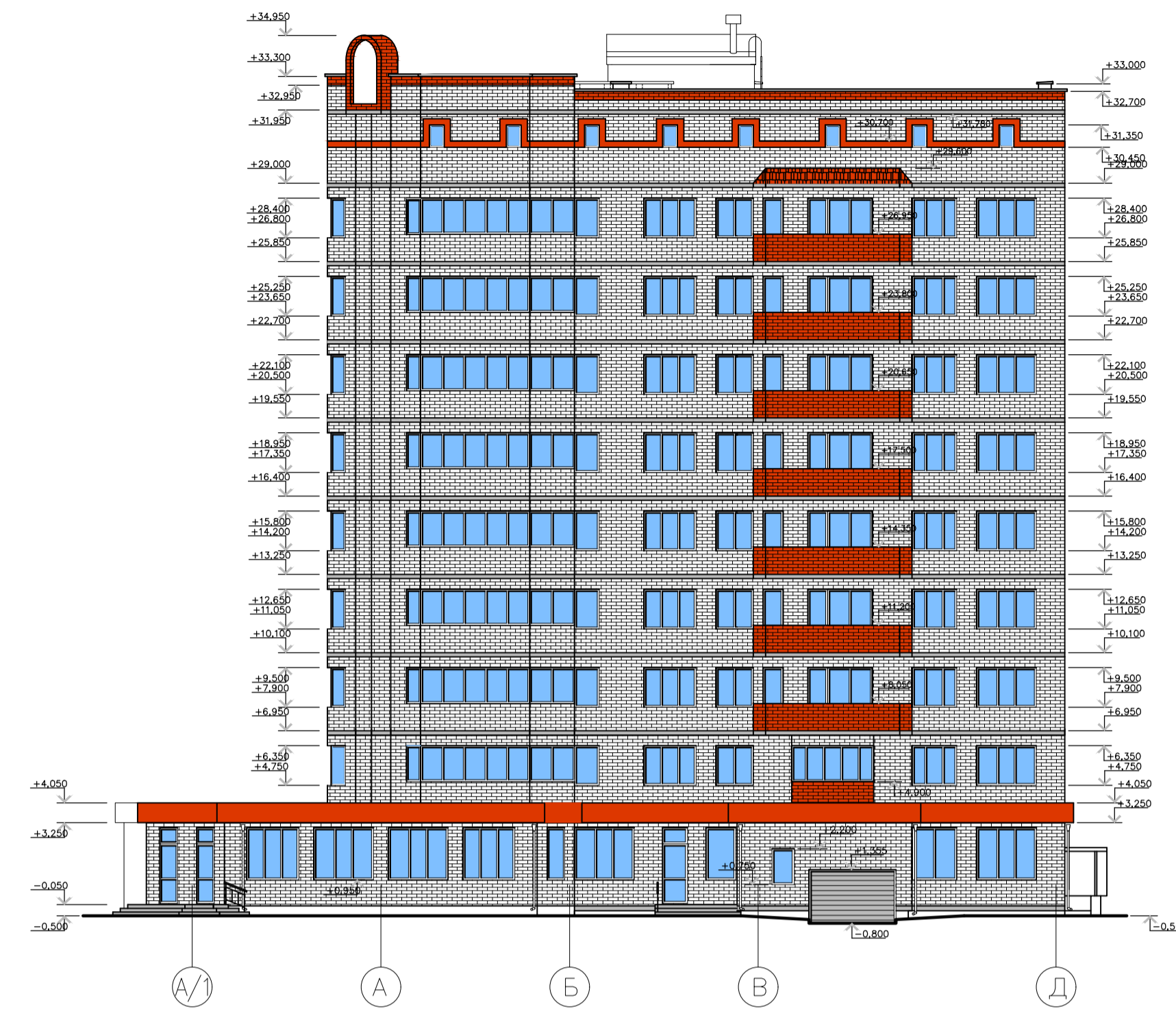
ФАСАД В ОСЯХ А/1 - Д
