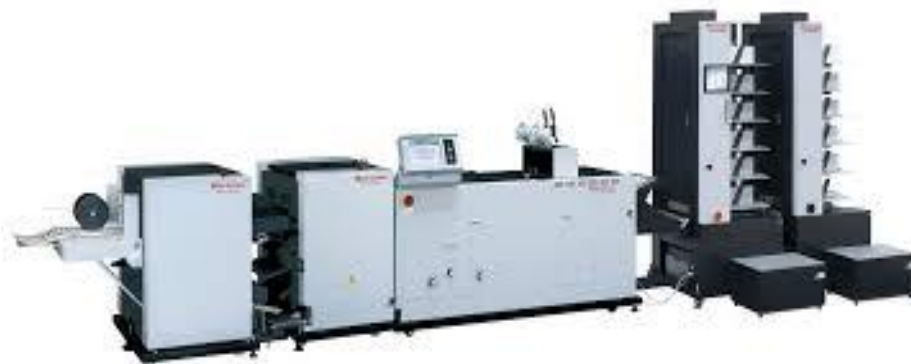
Рис.. 3.24. Дротоскобова зшивна машина Horizon SPF-200L
