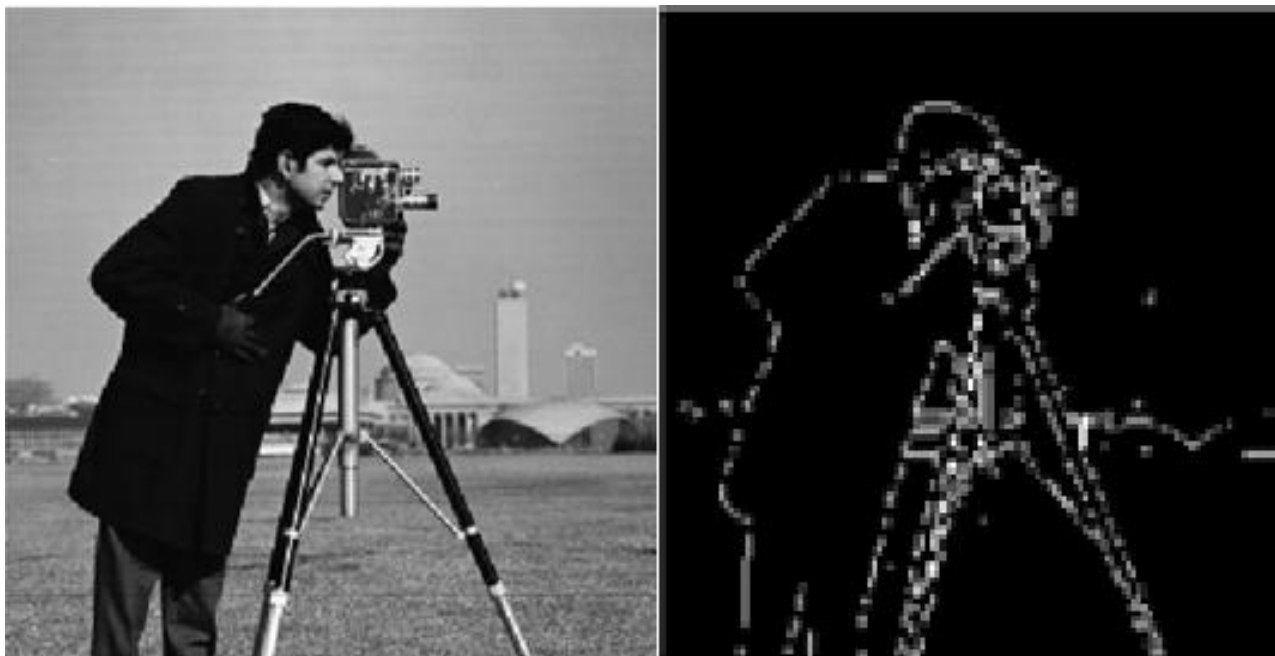
Рисунок 1.5 – Застосування фільтра Собеля [9]
