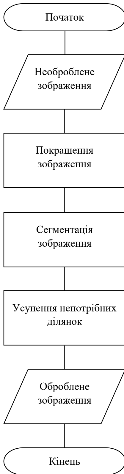
Рисунок.1.1 – Графічна схема алгоритму попередньої обробки зображення
