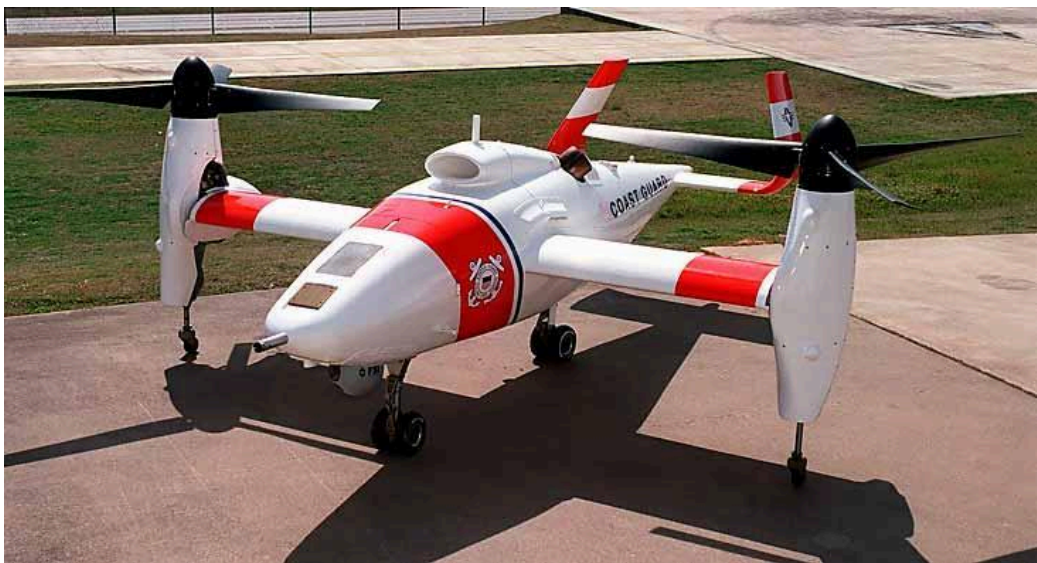
Рис. 1.2. Рятувальний безпілотний конвертоплан Eagle Eye , розроблений фірмою Bell для берегової охорони США
