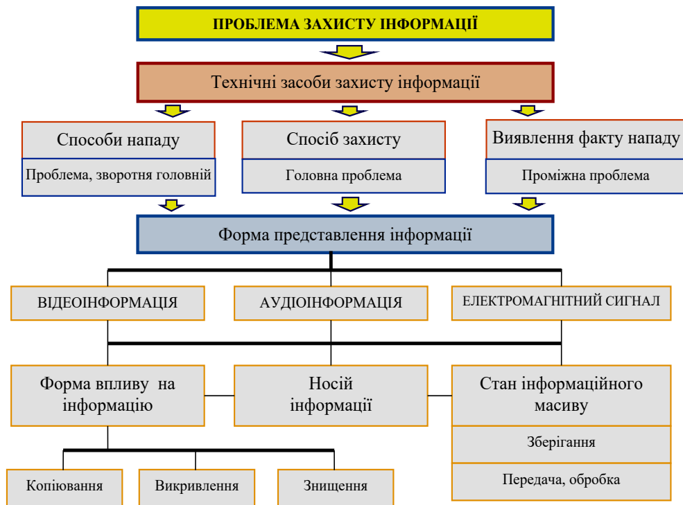
Рис. 2.6. Семантична схема проблеми захисту інформації за допомогою технічних засобів з позиції структурної ієрархії
