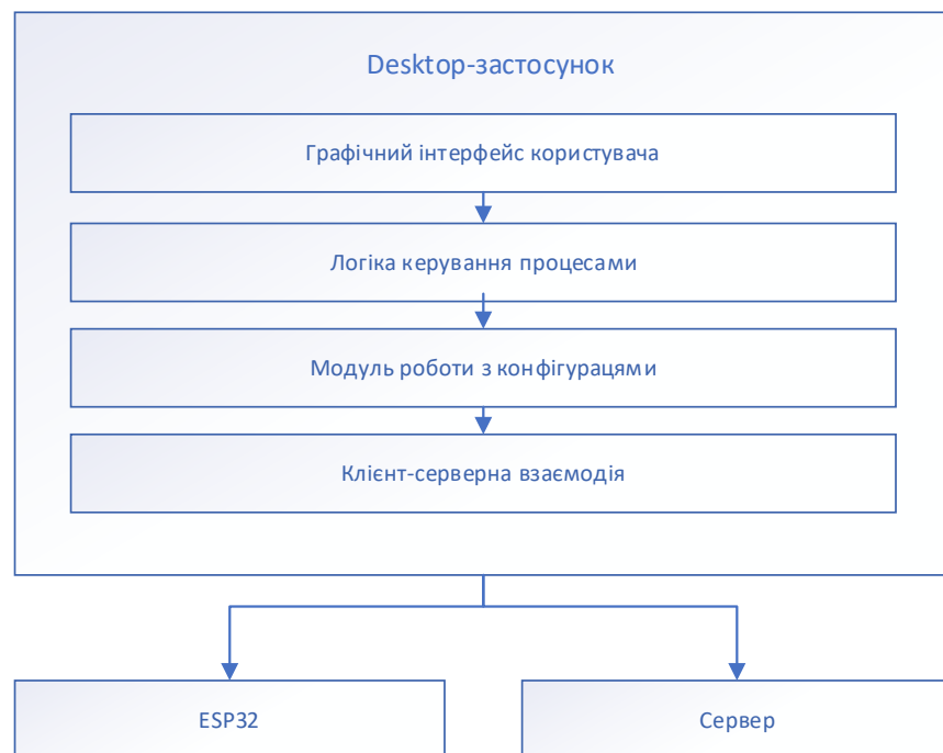
Рис. 3.1. Структурна схема програмного модуля віддаленого оновлення прошивки
