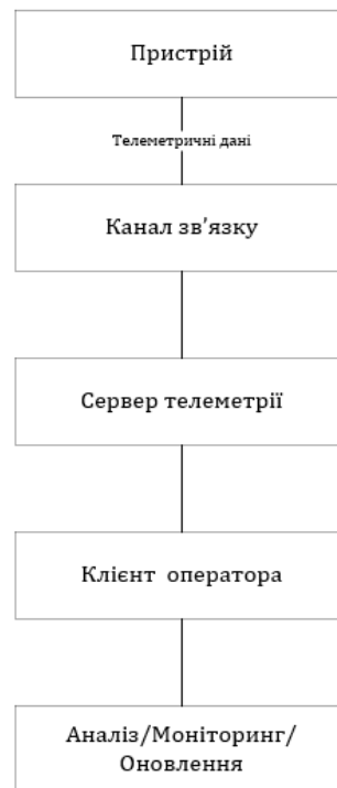
Рис. 1.1. Структурна схема телеметрії в наземній станції
