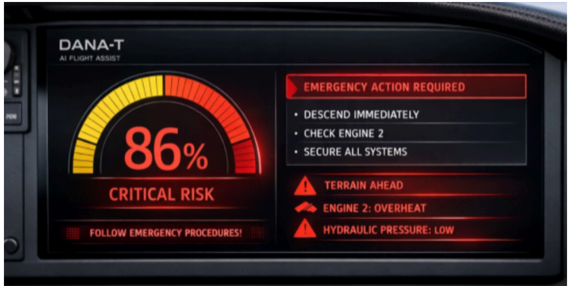
Рис. 2. Приклад вигляду програми при підвищенні рівня небезпеки до критичного
