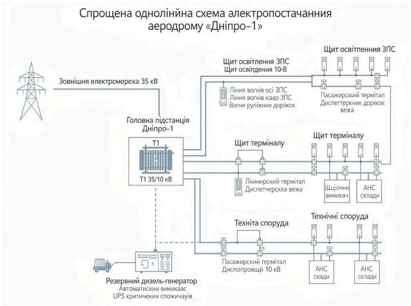
Рис. 2.3. Спрощена однолінійна схема електропостачання злітно-посадкового майданчика «Дніпро-1»
