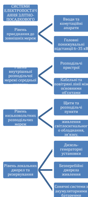
Рис.1.2. Структура системи електропостачання злітно-посадкового майданчика
