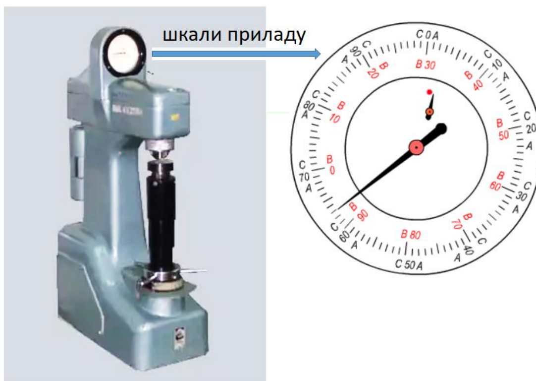
Рис. 2.7. Зовнішній вид приладу Роквелла та шкали індикатора.
