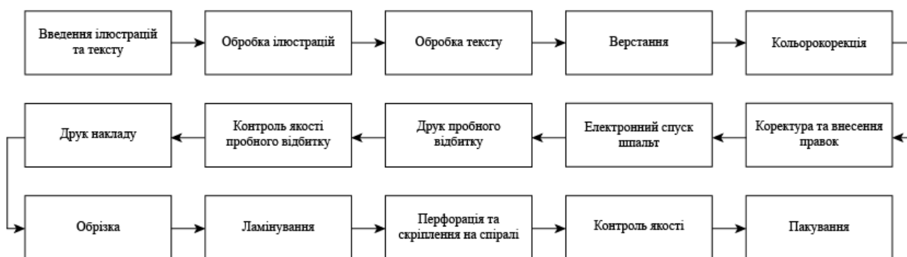
Рис. 3.12. Структурна схема технологічного процесу виготовлення календаря
