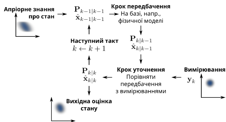
Рисунок 2.2. – Принцип роботи ФК
