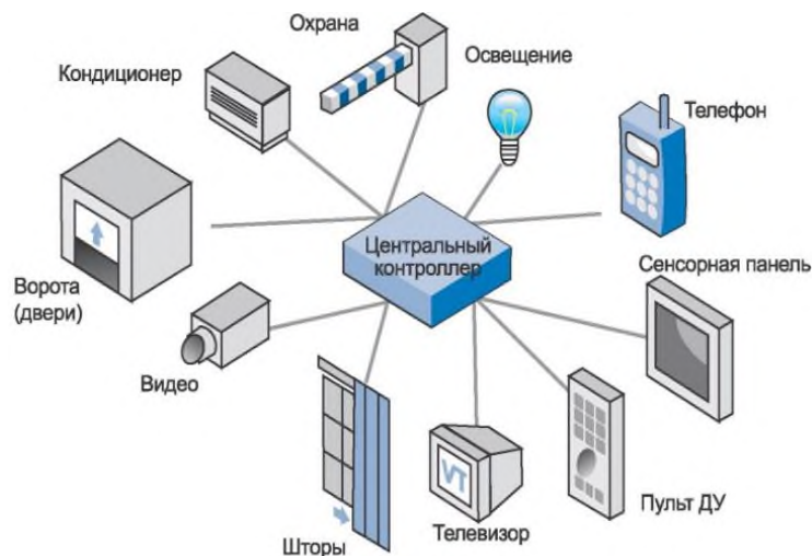
Рис. 1.5 – Центральний контролер та виконавчі елементи.
