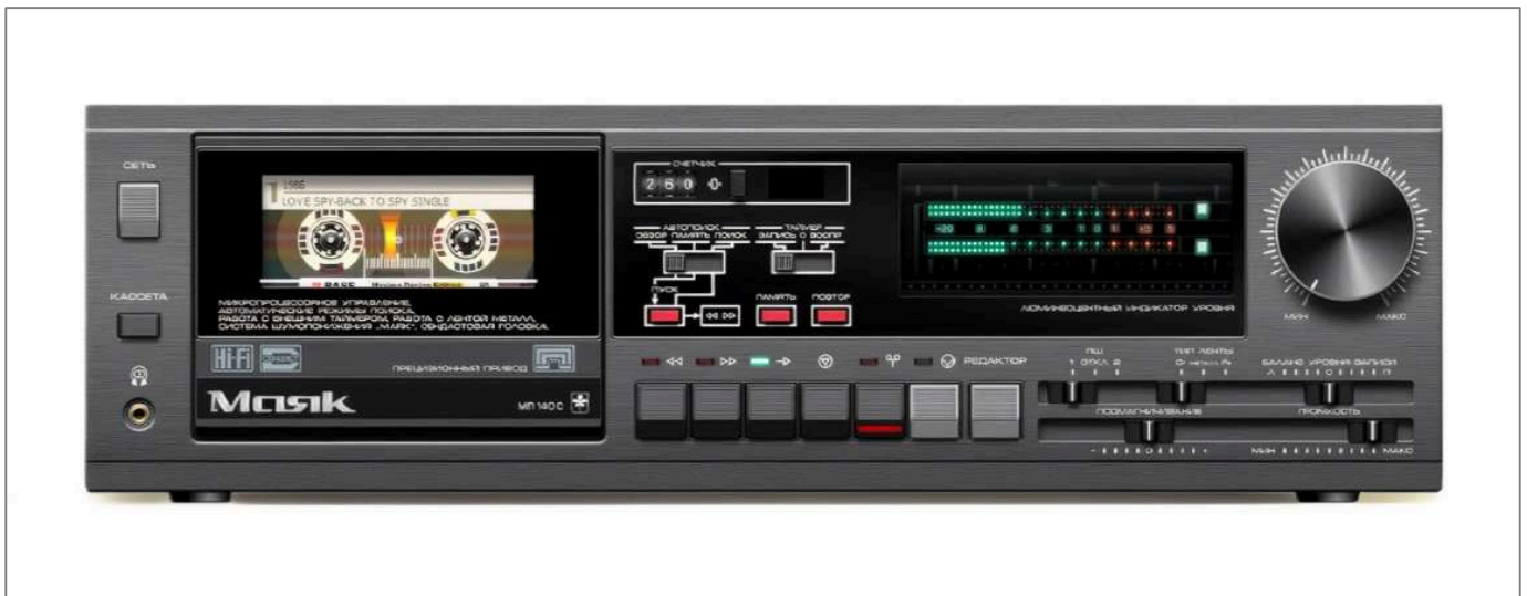
Рис. 1.4. Маяк-140 з вакуумно-люмінесцентним індикатором рівня (VFD)
