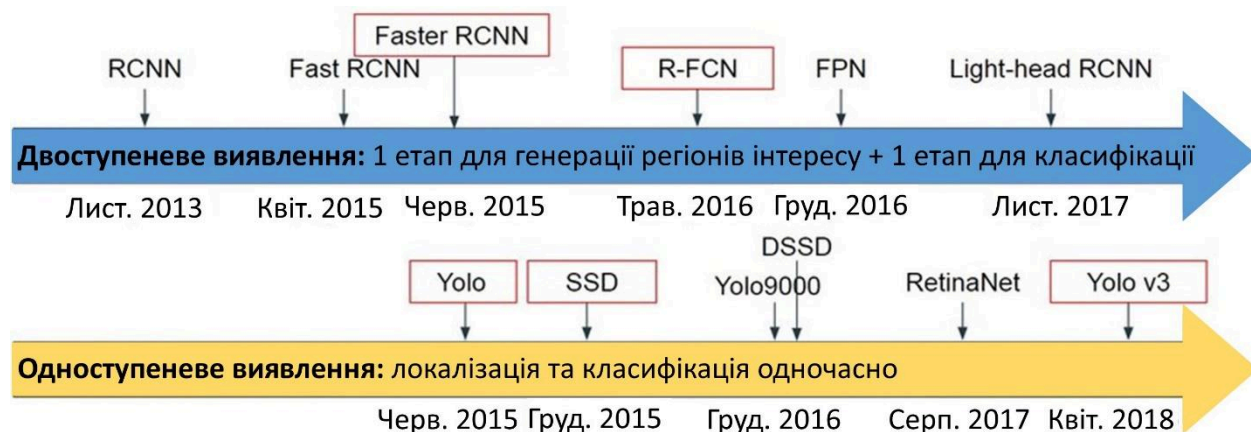
Рис. 1.2. Приклади еволюції CNN-архітектур для виявлення об'єктів: від двоетапної схеми R-CNN до одноступеневих моделей SSD та YOLO
