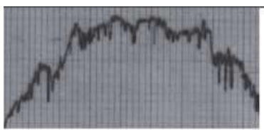
Рис. 2.19 . Профілограма поверхні зуба конічної шестерні після зміцнення (Ra = 0,45 мкм).
