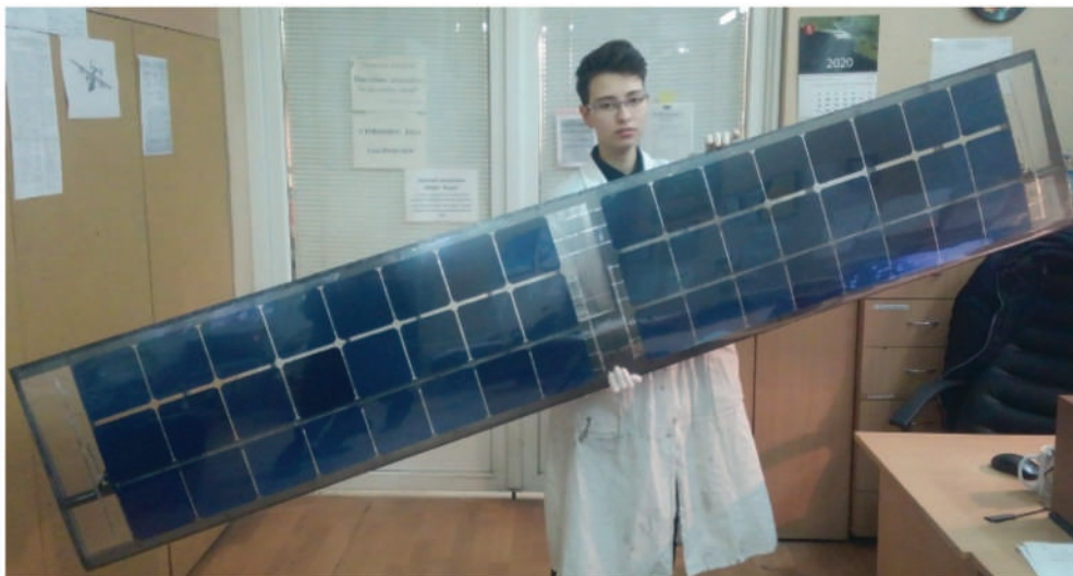
Рис. 6.18. Розташування секції з 48-и сонячних елементів на горизонтальному оперенні ПС-11 «Крокус»
