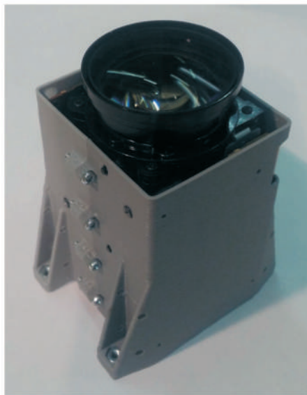
Рис. 4.5. Денна відеокамера SONY FCB-EV7500 в перехідному корпусі
