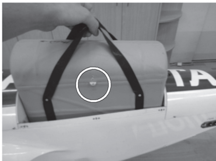
Рис. 3.6. Спеціальний вантажний контейнер для вантажу БПС М-6-3Т «Жайвір»
