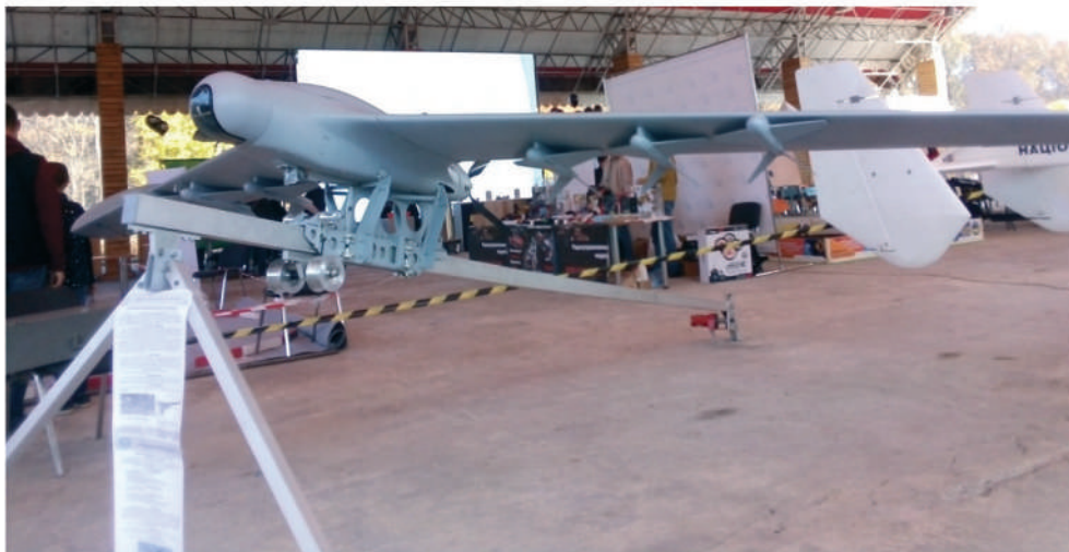
Рис. 4.30. Встановлення плануючого самокерованого міні-боєприпасу на борт авіаційного безпілотного носія М-56 «Модуль»
