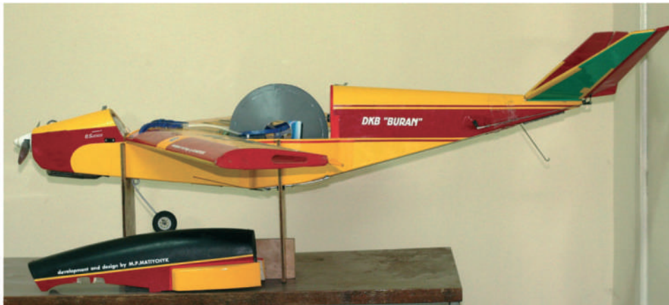
Рис. 4.22. Безпілотне повітряне судно М-6 «Жайвір» з відкритим відсіком дозатора
