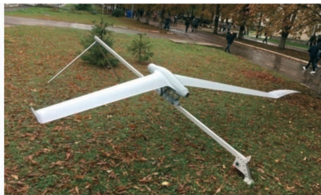
Рис. 4.27. Загальний вигляд БпАК М-56 «Модуль» у розгорнутому вигляді (БПС М-56 «Модуль» на пусковій установці КП-6)
