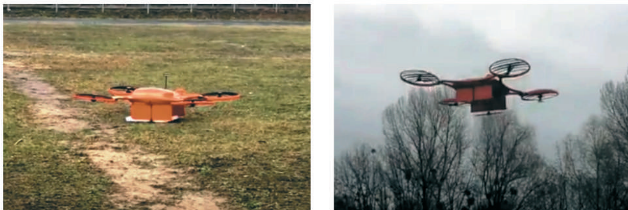
Рис. 3.4. Вигляд вантажного відсіку БПС ПКМ-14 «Сатурнія»: a – стулки відсіку в положенні «відкрито» і вантаж скинутий; б – стулки відсіку в положенні «відкрито», вантаж скинутий і вертоліт повертається на «базу»
