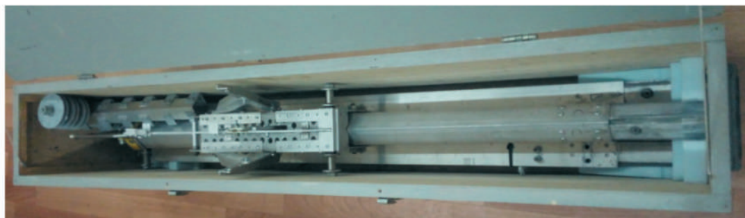
Рис. 4.7. Загальний вигляд та розміри пускової установки КП-5 у складеному стані (тара для КП-5 розміром 200×350×1200; маса разом із КП-5 близько 18 кг)
