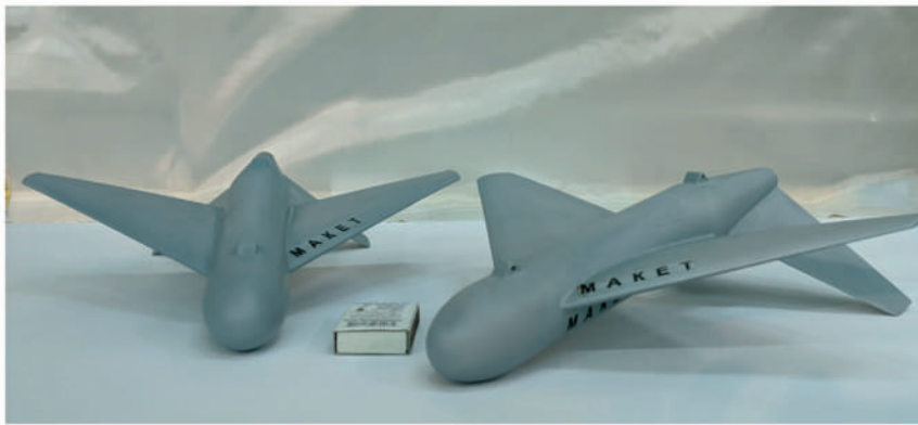
Рис. 4.28. Загальний вигляд плануючого самокерованого міні-боєприпасу ПМБ-03 (макет)
