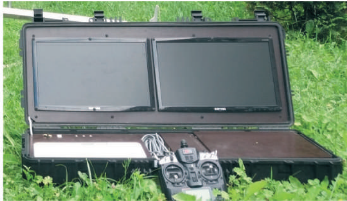
Рис. 4.11. Загальний вигляд наземної станції керування (наземний захищений комп'ютер у кейсі)
