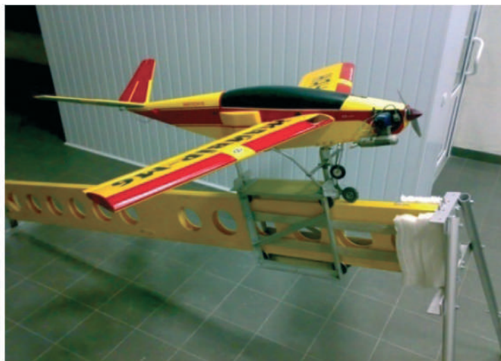
Рис. 4.21. Безпілотне повітряне судно М-6 «Жайвір» на пусковій установці
