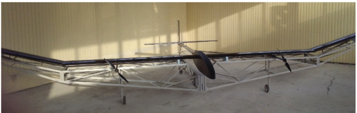
Рис. 6.15. Зовнішній вигляд (3/4 справа) стратосферного псевдосупутника ПС-11 «Крокус»
