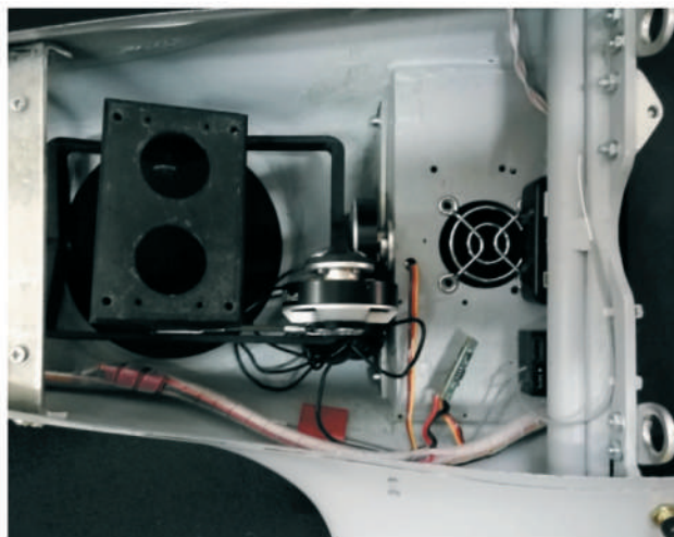
Рис. 4.2. Двовісний гіростабілізатор цільового навантаження БПС «ОВОД» М106 (вигляд зверху; ложемент силової батареї знятий)
