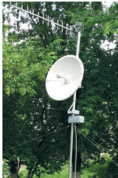
Рис. 4.12. Телескопічна щогла та пристрій автоматичного розвертання антен у напрямку БПС
