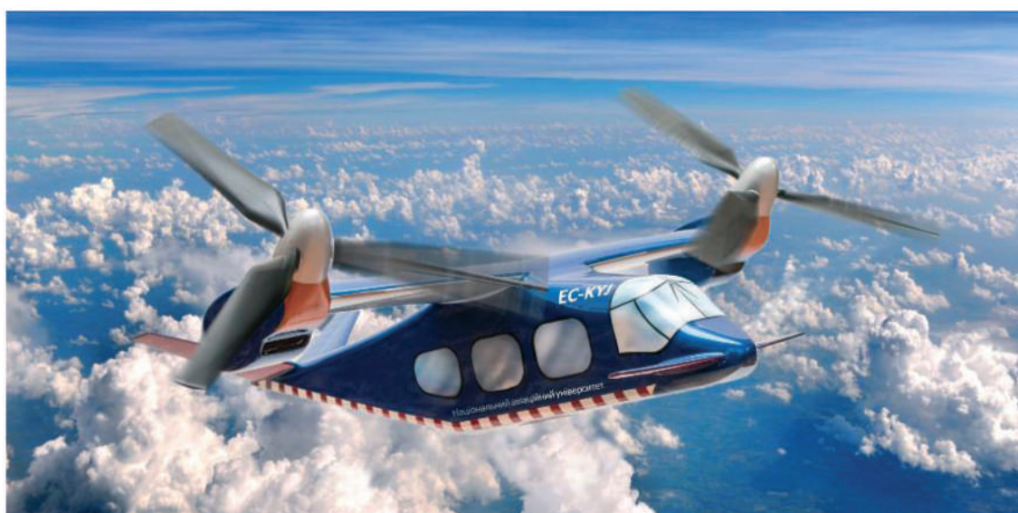
Рис. 6.13. Зовнішній вигляд багатоцільового двомоторного конвертоплана КМ-3 «Кубок»
