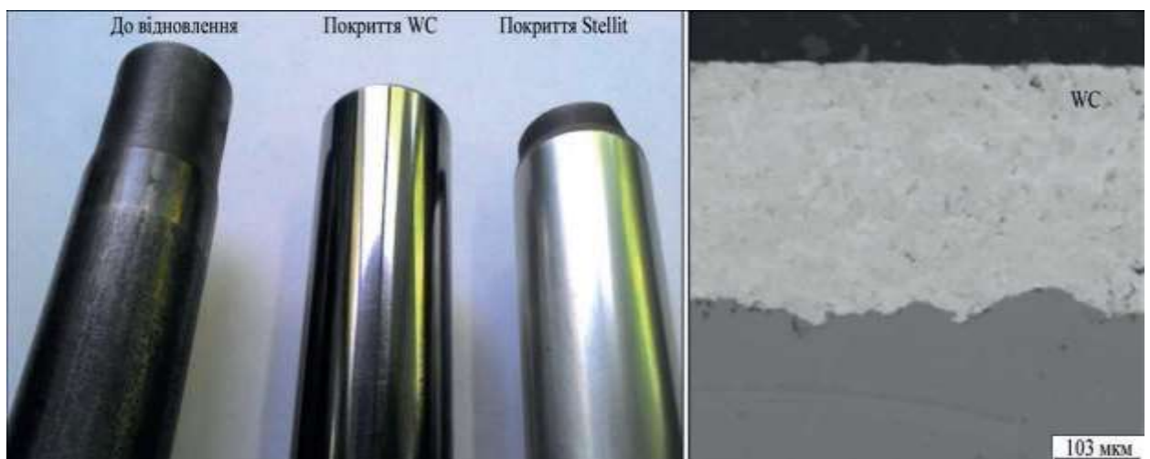
Рис. 6. Загальний вигляд валу після відпрацювання, відновлення з нанесенням зносостійких покриттів типу WC та Stellite та мікроструктура покриття W
