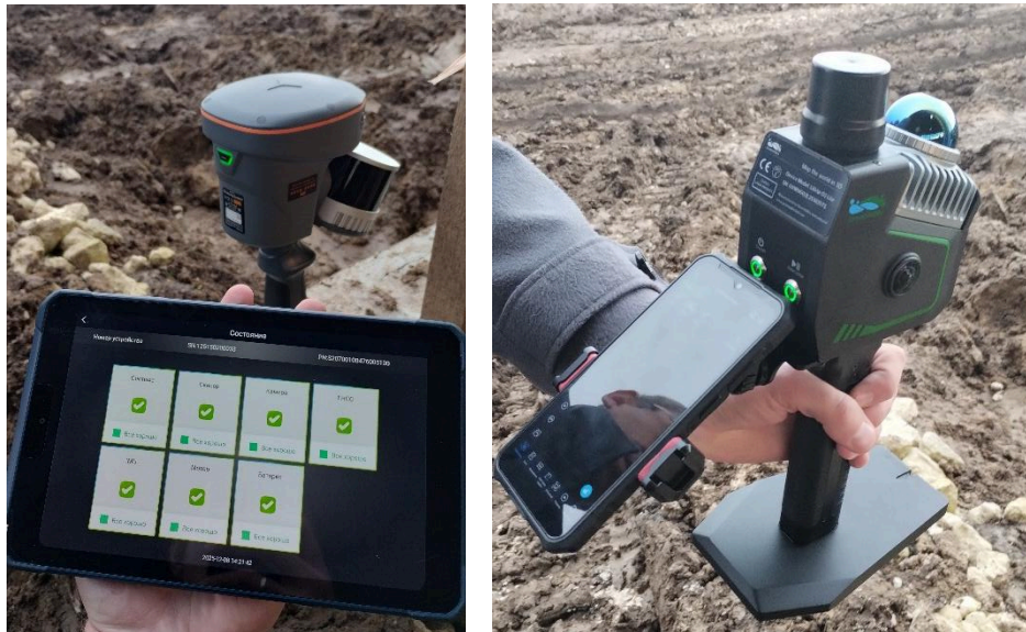
Рис. 2.2 Сканери CHCNAV RS10 та GreenValley LiGrip O2 Lite
