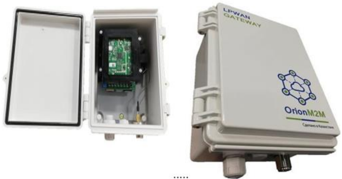
Рис. 1.4. Базова станція ORION gateway
