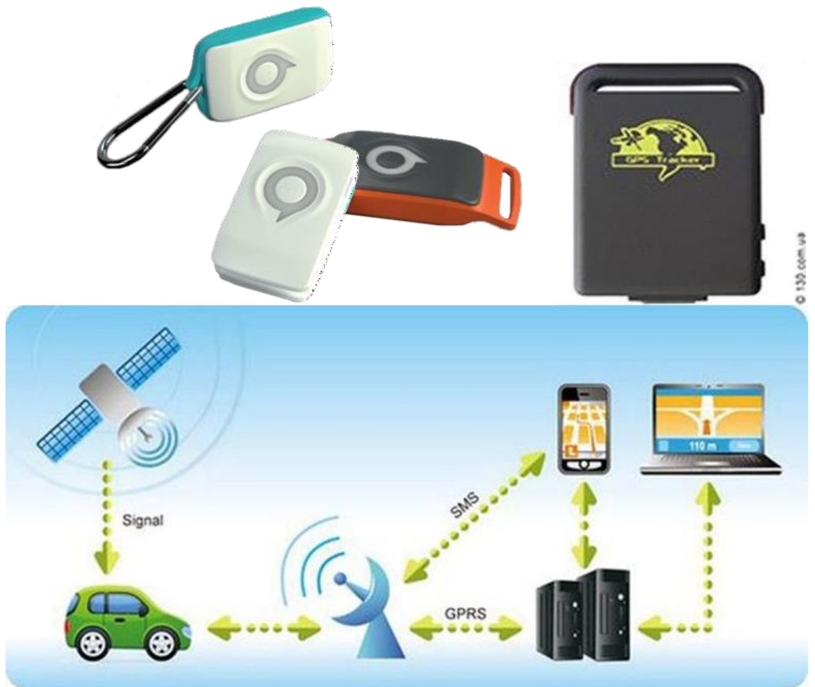
Рис. 1.9. GPS трекер и принцип його роботи
