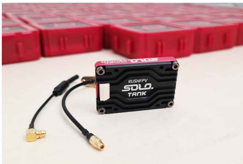
Рис 4.10 – відеопередавач RushFPV RUSH TANK SOLO 5.8GHz 1600mW
