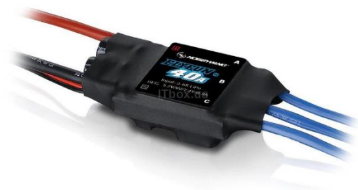
Рис 4.4– регулятор ходу HobbyWing Flyfun-40A
