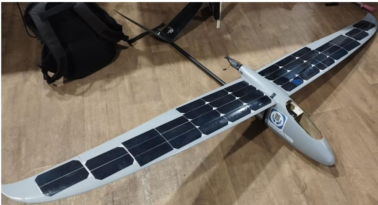
Рис 1.1 – приклад корпусу БПЛА класу «Планер»
